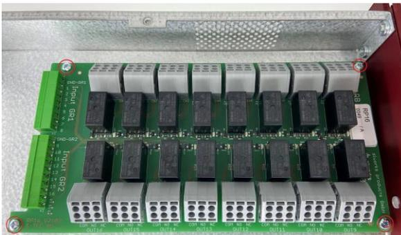
Abbildung 4: Montage Relaisbox T941RB im 19" 1HE Rackmount
