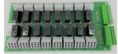
Abbildung 1: Relaisbox T941RB
